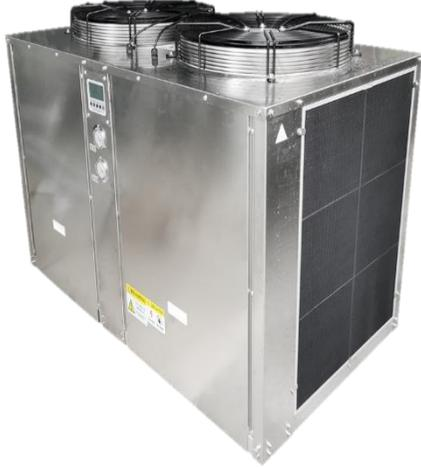
يتم استخدام المضخات الحرارية للحفاظ علي درجة حرارة المياه في النطاق المناسب للأنواع المختلفة من الأسماك من 16-28 درجة مئوية ويحتوي علي اجهزة الحماية الكهربائية من سقوط احد الفازات او انخفاض الجهد او الحمل الزائد للمضاطة او الحماية من الحمل الزائد لمضخة المياه ، يمكنها التنبيه وعرض الاعطال في اي وقت .
